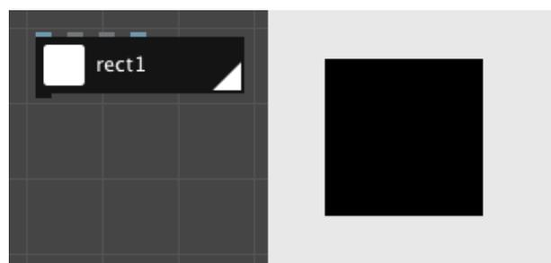
2. Nous connectons un nœud de **colorisation** au nœud de **rect** . Ce nœud prend la sortie du nœud de **rect** et change sa couleur. Nous appelons cela un nœud de filtre, car elle filtre une forme existante.
